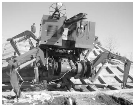
<写真3> 4足歩行型法面作業ロボット「TITAN XI」
